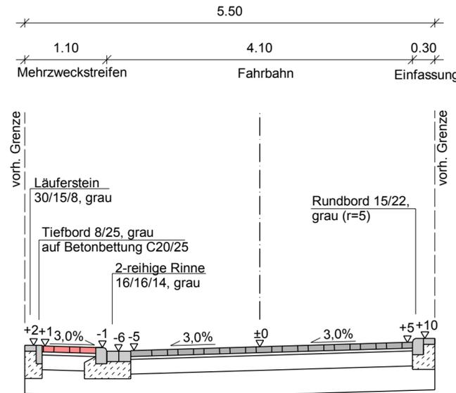
8 cm Betonsteinpflaster Basalit Plus plan
