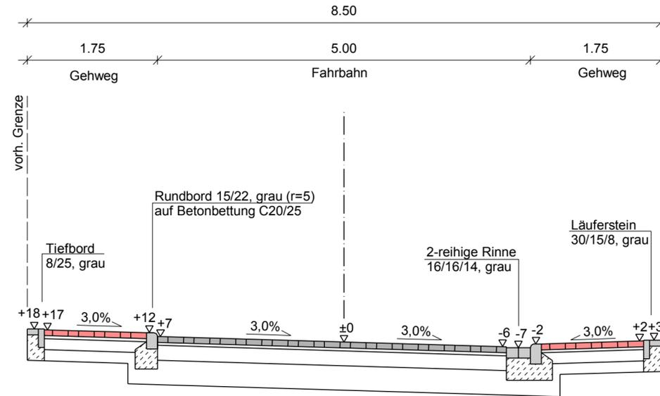
8 cm Betonsteinpflaster Basalit Plus plan
